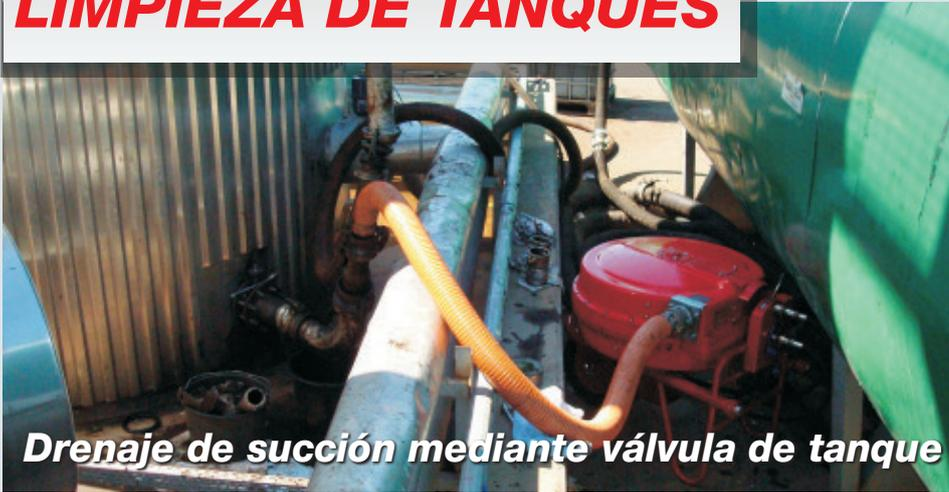
El alto poder de vacío de la bomba mejora la eficacia de succión a partir de una válvula ubicada en la parte inferior de una gran variedad de tanques, como los tanques de residuos (slop). Esta forma de conexión simple permite una limpieza total más sencilla y rápida con poca preparación y menos problemas de acceso.
