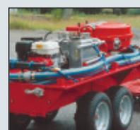
La facilidad de transporte del sistema es todavía mayor gracias a las manijas que se pueden fijar tanto a la bomba como la unidad motriz y se utilizan para elevarlo en terrenos difíciles o para trasladarlo como una carretilla. También hay disponible un acoplado todo terreno o tipo oruga con remolque para transportar la bomba y la unidad motriz al área afectada. El remolque también se puede utilizar para transportar pequeñas cantidades de aceite en sacos o barriles al área de recolección.
